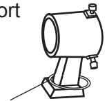
Anneau en caoutchouc (à retirer avant le montage)
